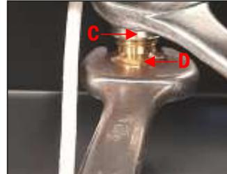
**4-**Luego sujete el Piloto Analizador **“E”** con una llave y con la otra retire el inyector Piloto **“C”**. Reemplácelo por el inyector provisto y vuelva a conectar el caño del Piloto Analizador. No olvide volver a ajustar la tuerca con virola **“B”** aflojada en el paso 2.
