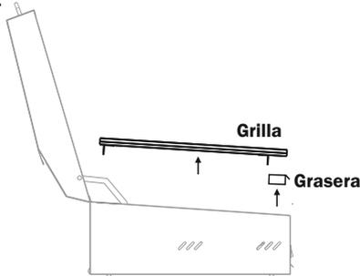
2) Al reinstalar las piezas, comience colocando la grasera, seguida de la grilla, asegurándose de que la parte frontal de la grilla encaje correctamente dentro de la grasera (VER DETALLE A). Cuando coloque la grilla, revise que la parte trasera quede lo más próxima posible al borde, alineada con el perfil (VER DETALLE B) (**fig. 2**).
