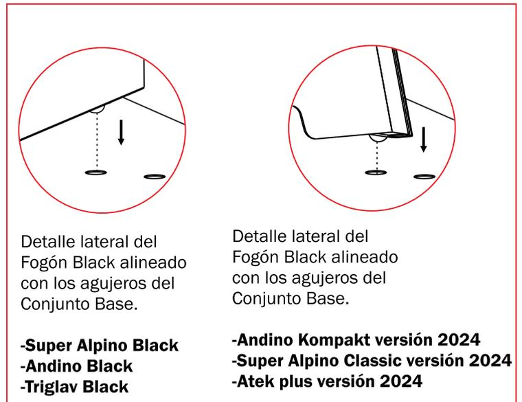
**IMPORTANTE:** Levantar las pestañas que se encuentran en el piso del Conjunto Base con la ayuda de un destornillador plano, para que las patas traseras del Fogón queden trabadas y fijas.
