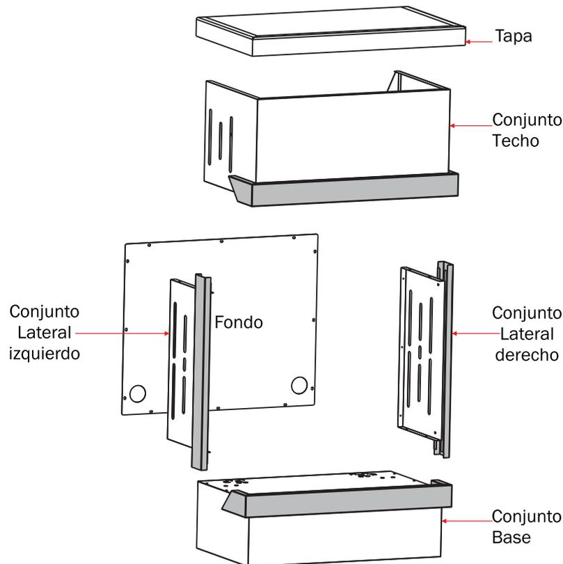
**IMPORTANTE:** Para facilitar el armado, se recomienda colocar los tornillos sin apretarlos totalmente hasta que todas las partes estén ensambladas. Esto permite la correcta alineación de las perforaciones.
