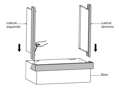
Rotar el conjunto armado en el paso anterior y atornillar el Fondo con los Laterales derecho e izquierdo usando 6 tornillos y luego a la Base con 3 tornillos más. Tener en cuenta que los aqujeros para la entrada del caño de gas queden hacia abajo como muestra el dibujo.
