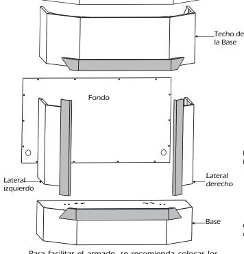
Se inserta los laterales derecho e izquierdo en la guarda de la Base y se atornillan con 6 tornillos.
