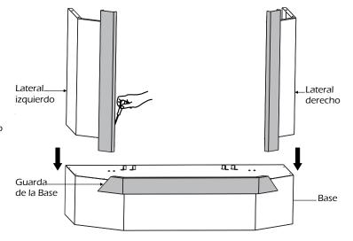
Para facilitar el armado, se recomienda colocar los tornillos sin apretarlos totalmente hasta que todas las partes estén ensambladas. Esto permite la correcta alineación de las perforaciones.
