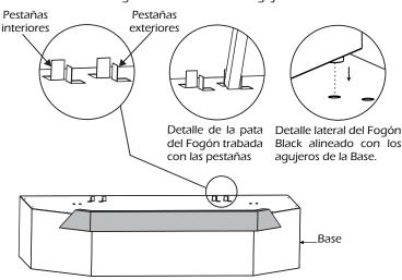
Rotar el conjunto armado en el paso anterior como muestra el dibujo, y atornillar el Fondo con los Laterales derecho e izquierdo usando 6 tornillos y luego a la Base con 4 tornillos más. Tener en cuenta que los agujeros para la entrada del caño de gas queden hacia abajo.
